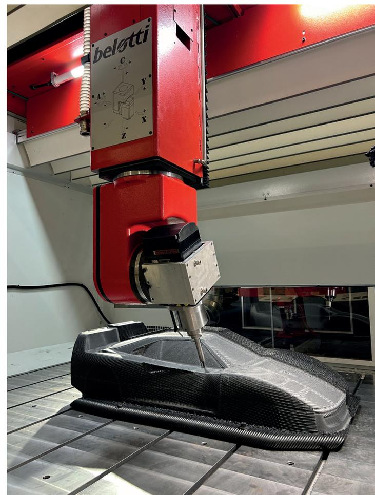
**Lavorazione sulla macchina BEAD, tecnologia ibrida che integra in un unico centro di lavoro, equipaggiato con il CNC Sinumerik ONE, i processi di fresatura e stampa 3D su larga scala.**
