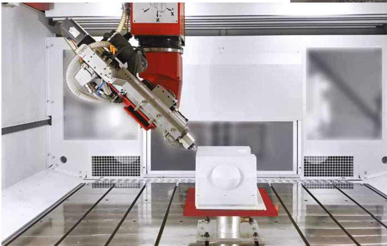
Impression additive avec orientation de l'extrudeur à 45 degrés.
