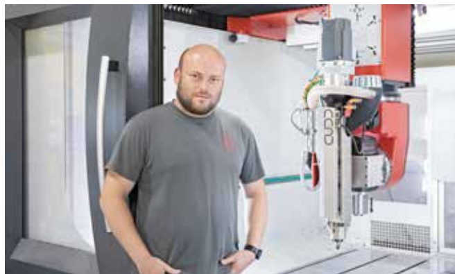
Jochen Stefani veranschaulicht: „Wir erforschen in Kooperation mit Belotti, wie wir Bauteilaufnahmen aus ABS-CF20 drucken können. Das Material hat nahezu keine Schwindung, was hohe Maßtoleranzen garantiert.“
