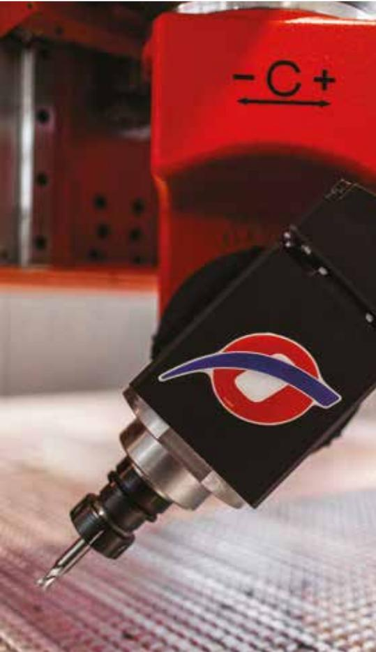
Uno dei componenti più soggetti a usura, o a eventi accidentali che ne compromettono il funzionamento, è sicuramente l'elettromandrino. Per questo Belotti gestisce revisioni e riparazioni delle varie tipologie di elettromandri montati sui centri a controllo numerico.
