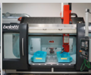
Rifilatura modello in resina
