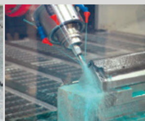
Lavorazione fibra di carbonio con refrigerante
