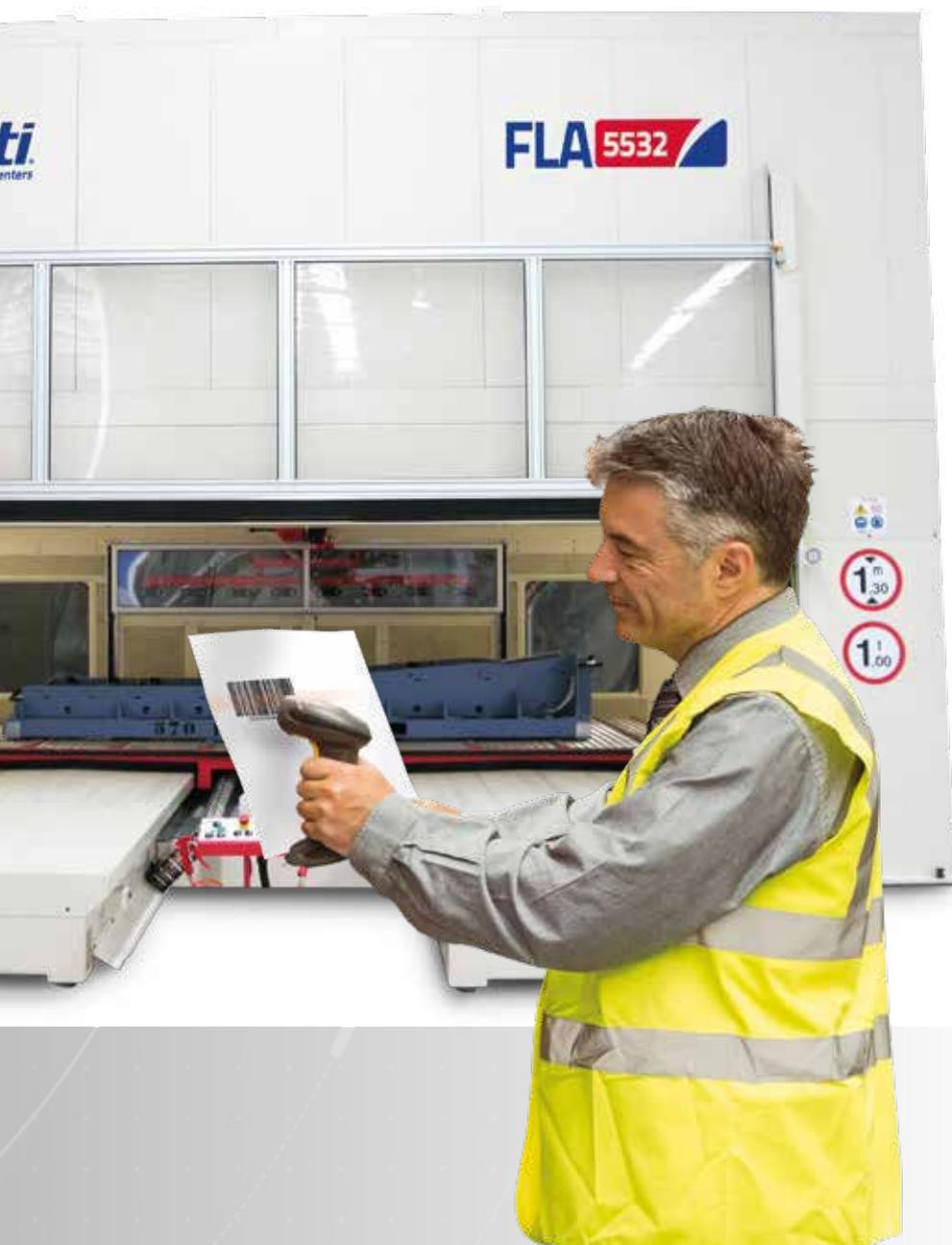
BARCODE permette di selezionare e di attivare automaticamente i programmi di lavorazione leggendo un qualsiasi codice a barre che ne identifichi il numero o la sigla. L'integrazione di questo software nella Suite MyB significa **maggiore efficienza, (tramite la velocizzazione dell'attivazione dei programmi, il cambio attrezzatura) e l'abbattimento drastico dell'incidenza degli errori da parte dell'operatore.**
