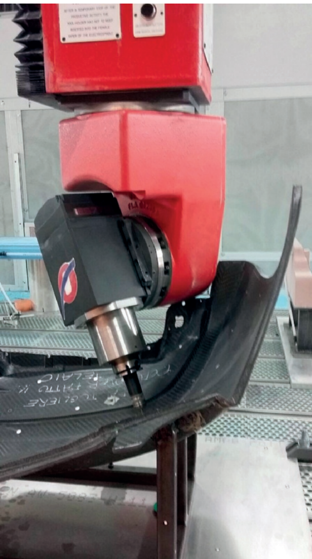
Fig. 2 - Dettaglio lavorazione componente in carbonio su centro di lavoro a 5 assi Belotti FLA 6532.
