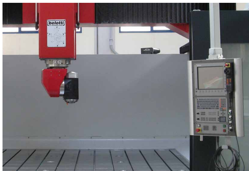
iTNC 530 di HEIDENHAIN controlla il centro di lavoro Belotti su esplicita richiesta di Persico Marine.
